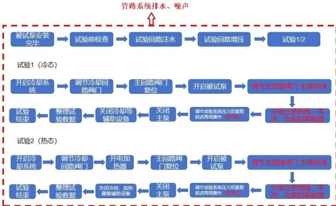
图 2-2 运营期工艺流程及产污节点图
